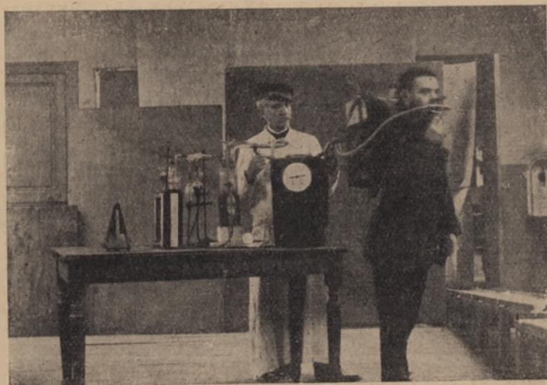
FIG. 132. — Mesure des échanges gazeux d'un homme chargé (dispositif de l'auteur).
