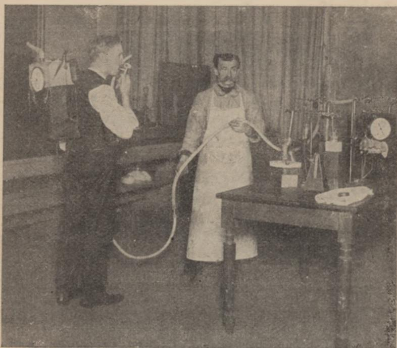
FIG. 230.— Appareil d'échantillonnage et de mesure des gaz respiratoires (J. Amar).
