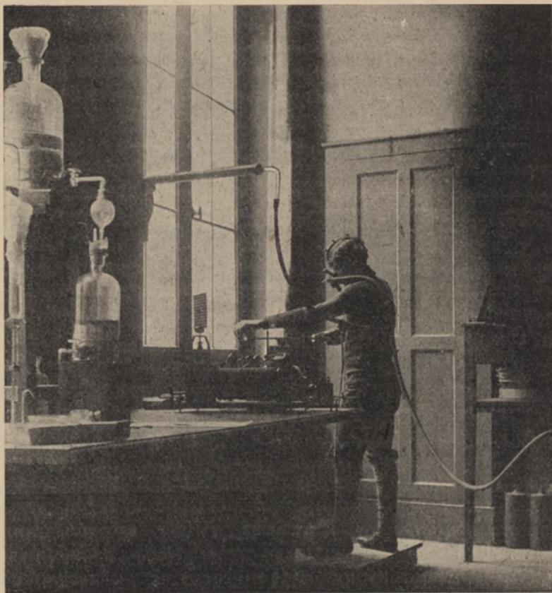
FIG. 290. — Travail d'un apprenti limeur (agencement des appareils pour enregistrer les efforts et mesurer les échanges gazeux).
