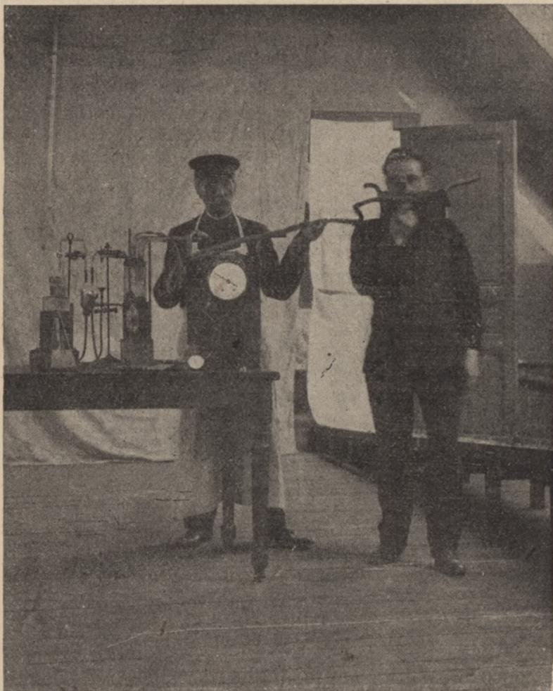
FIG. 281. — Dispositif pour mesurer la consommation d'oxygène dans la marche (Jules Amar).
