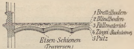
Fig. 118. Massive Zwischendecke aus Eisenträgern und Ziegeln.
