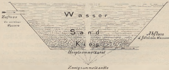
Fig. 86. Schema eines Filters.
