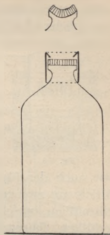
Fig. 217. Sterilisation der Kindermilch nach Soxhlet.
