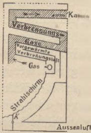
Fig. 131. Doppelregenerativ-Gasofen von Schäffer und Walker.
