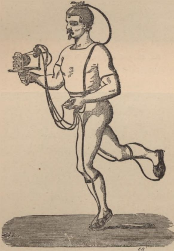
FIG. 27. — Coureur muni des appareils destinés à enregistrer ses mouvements
